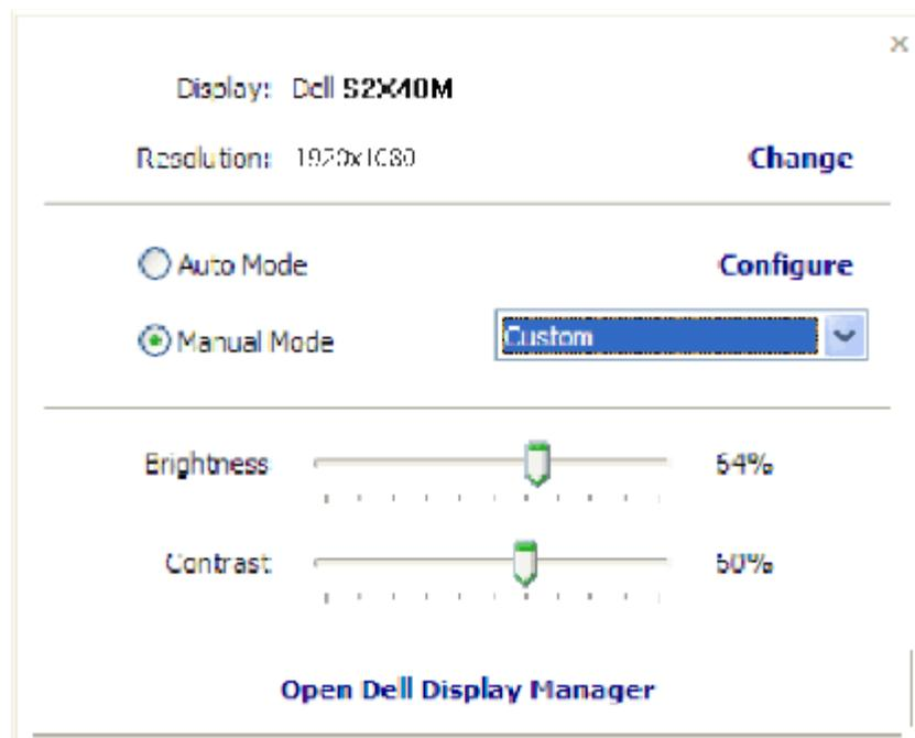
El cuadro de diálogo Configuración rápida también proporciona acceso a la interfaz de usuario avanzada de Dell Display Manager, que se utiliza para ajustar funciones básicas, configurar el modo automático y acceder a otras funciones.
